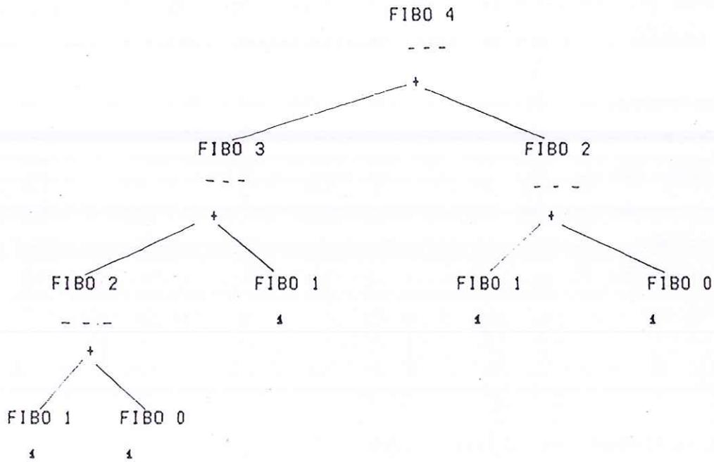
Voici l'évolution de la pile d'exécution. Sitôt qu'un calcul est possible, les blocs d'activation inutiles sont dépilés. Les nombres en gros chiffres sont les arguments d'appel successifs de FIBO, ceux en petits chiffres les résultats des appels
