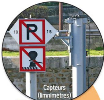
**1** Disposition de **1300 capteurs** (limnimètres) dans les cours d'eau surveillés. Chaque capteur est relié à une station d'acquisition de données équipée d'un système de transmission.
