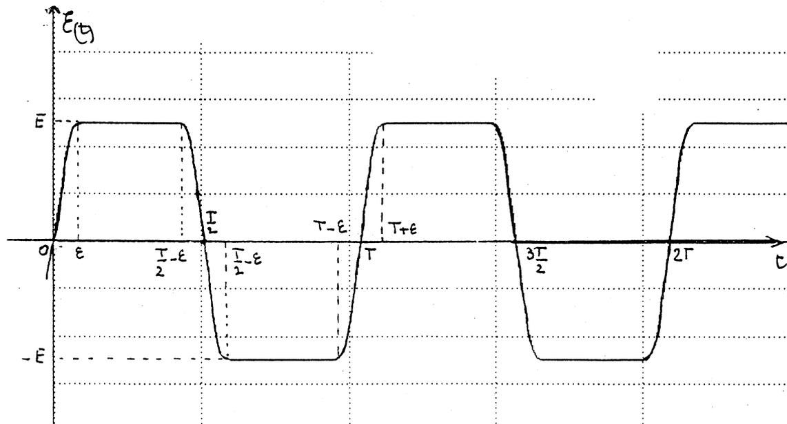
Dans ce cas, la sortie est le signal  $s = \tau \mathcal{X}'$  avec  $\tau = \frac{1}{RC}$  et  $\mathcal{X}'$ , représentée ci-dessous, dérivée de  $\mathcal{X}$ .
