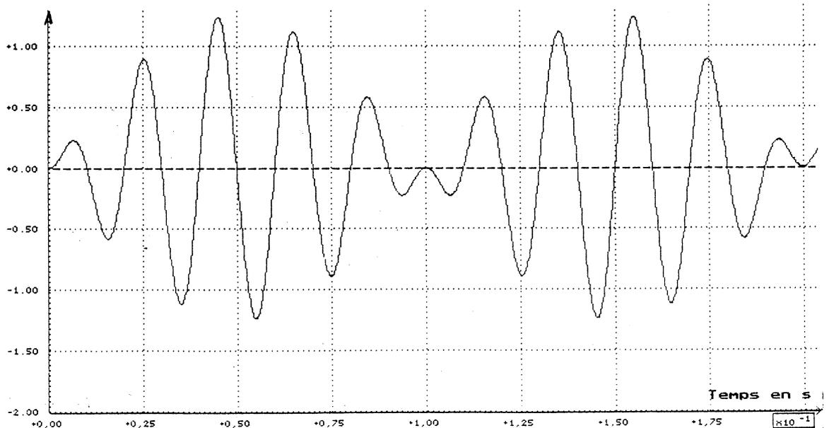
C'est un signal modulé en amplitude avec un taux de modulation infini.
