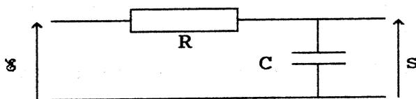
$$\mathcal{X} = \left[ \frac{1}{1 + i \frac{\omega}{\omega_0}} \right] , \text{ où } RC = \frac{1}{\omega_0}$$
