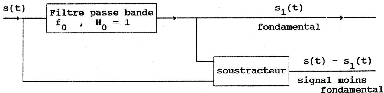
On peut en utilisant un voltmètre R.M.S. mesurer la valeur efficace de  $s_1(t)$  (fondamental) et de  $s(t) - s_1(t)$  (signal moins fondamental) et donc en déduire le taux de distorsion harmonique.
