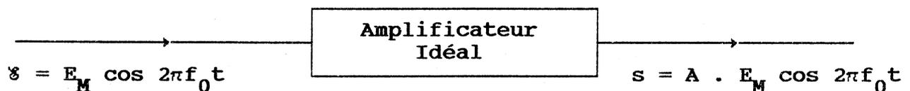
En réalité, l'amplificateur n'est jamais parfait et le signal de sortie n'est pas parfaitement sinusoïdal (déformation du signal).
