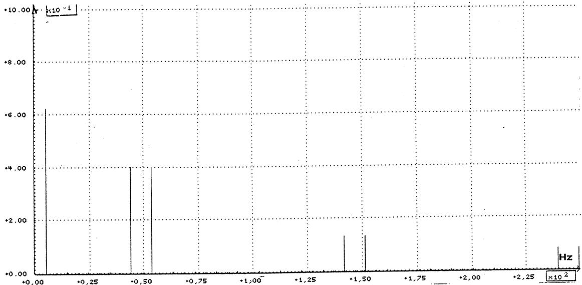
Si on ne conserve que les signaux sinusoïdaux de fréquence  $f - F$  et  $f + F$ , on obtient un signal  $g$  tel que :
