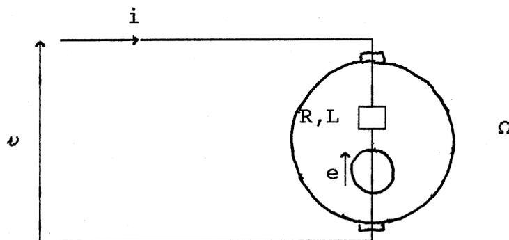
La grandeur d'entrée est la tension  $v$  appliquée aux bornes du moteur  $v = V \mathcal{U}(t)$ .
