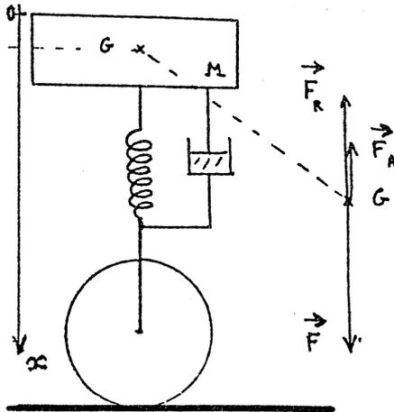
Au repos le poids est compensé par la réaction du ressort.
