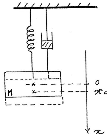
Par ailleurs le ressort et l'amortisseur sont reliés à un support fixe. Le solide est écarté de sa position d'équilibre d'une distance  $x_0$  et abandonné sans vitesse initiale.
