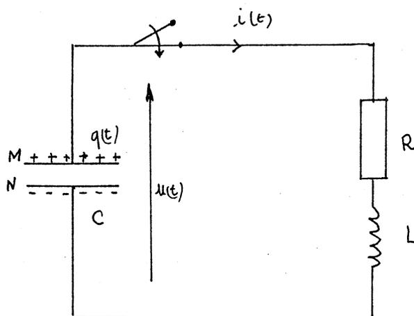
L'équation de la décharge s'écrit :  $L \frac{d^2q}{dt^2} + R \frac{dq}{dt} + \frac{q}{C} = 0$  (A)
