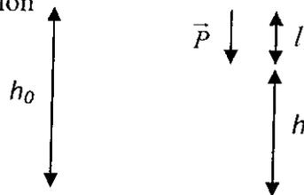
Sous l'action de la force  $\vec{P}$ , la hauteur est diminuée de la longueur  $l$ .
