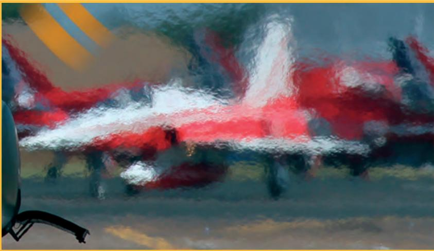
Effet de la turbulence de l'air : une tuyère souffle de l'air chaud qui brouille l'image de l'avion.
