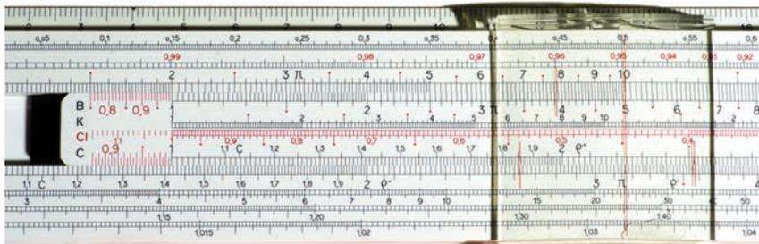
Une règle à calculs est composée de trois réglettes dont une coulisse entre les deux autres. En faisant coïncider la graduation 1 de l'une et la graduation 2 de l'autre, puis en alignant le curseur sur la graduation 5 de la première, on lit le résultat de la multiplication  $2 \times 5$  sur la seconde.
