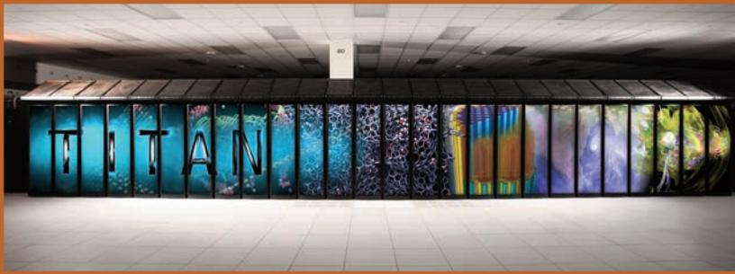
Titan, l'un des calculateurs les plus puissants au monde est capable de traiter par seconde 17 millions de milliards d'opérations.
