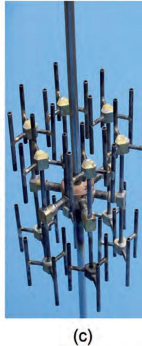
*Illustration 2* : (a) Schéma d'un injecteur fractal immergé dans un réacteur gaz/solide ou gaz/liquide. Un flux  $Q_s$  est introduit par l'injecteur fractal ; un flux additionnel  $Q_p$  est introduit par un distributeur au fond.
