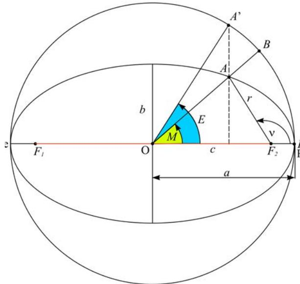
Figure 4 : Mouvement elliptique
