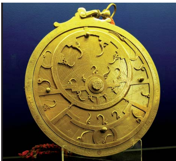
Astrolabe persan. On distingue nettement l'araignée ajourée, avec ses crochets qui correspondent à la position des étoiles. Sous l'araignée mobile se trouve le tympan avec ses cercles d'azimut, de hauteur, d'heure, etc.
