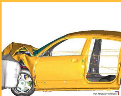
Simulation d'un essai de choc frontal d'une Citroën C6
