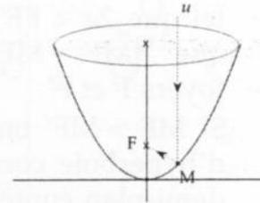
Inversement, un rayon issu de  $F$  se réfléchit suivant une droite parallèle à l'axe. C'est cette propriété qui est utilisée dans les applications suivantes :
