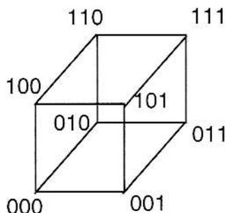
Si j'envoie plus de bits, on se trouve dans des espaces de dimensions supérieures. Par exemple avec 4 bits, on aura l'hypercube, cube à 4 dimensions, avec ses 16 sommets.
