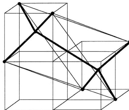
La structure tubulaire ci-contre (en traits épais) a été créée à partir d'un réseau de cubes de 1 m d'arête (en traits fins) et de leur structure tétraédrique. Les traits moyens représentent des câbles.
