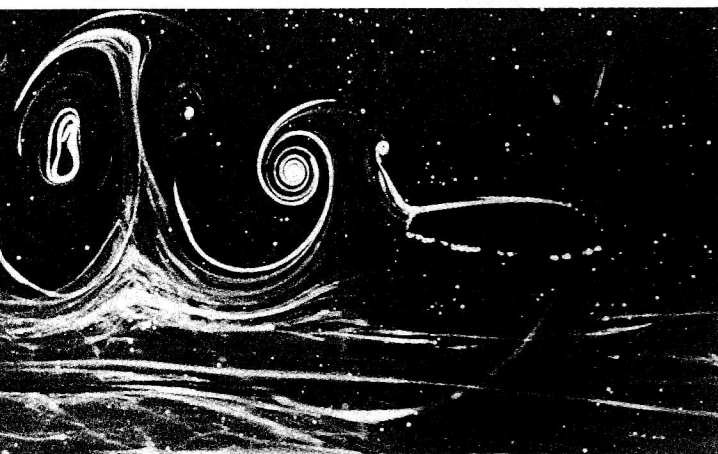
Aile de tangage. Tourbillon de bord de fuite. (Cliché A. Morand, CNRS-IMST)
