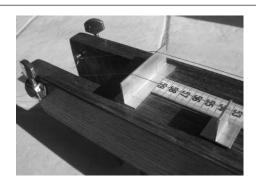
corde de longueur 1, et un autre son, obtenu en réduisant la longueur de la corde vibrante (sans la couper !) en utilisant un chevalet mobile (à droite sur les photos).
