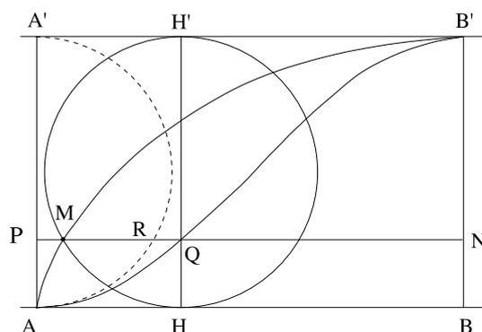
Lorsque le cercle de diamètre  $HH'$  ( $= 2r$ ) roule sans glisser de A à B ( $AB = \pi r$ ), le point M de celui-ci décrit un demi - arc de cycloïde  $AMB'$ .
