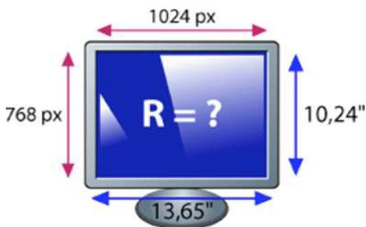
Les caractéristiques de cet écran nous permettent de savoir combien de pixels s'affichent (sa définition) : 1024x768, soit environ 800 000. Et quelle est alors la taille d'un pixel, ou le nombre de pixels par cm ou par pouce (ppp) ? C'est la résolution R qui est demandée sur ce schéma : 75ppp. Le pouce c'est 2,54 cm, ce qui fait entre 29 et 30 pixels par cm, soit environ 3/10 de mm pour la taille du pixel.
