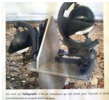
Son nom est l'héliographe. C'est un instrument qui est utilisé pour mesurer la durée d'ensoleillement en un point précis sur terre.
