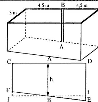
L'aire de la base trapézoïdale CDEF du prisme est la même que celle du rectangle CDJI dont la longueur des côtés CJ et DI est égale à la demi somme des bases du trapèze, c'est-à-dire à la longueur de la règle AB.
