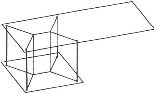
Lorsque j'ai, selon ses instructions, trempé l'objet dans de l'eau savonneuse, il s'est formé, en le retirant, une pellicule ayant la forme de demi-prismes droits à base hexagonale (du type des alvéoles de cire d'abeille, *fig. 2*). Il s'agissait donc là de la surface d'aire minimale contenant les 4 tiges de cuivre.
