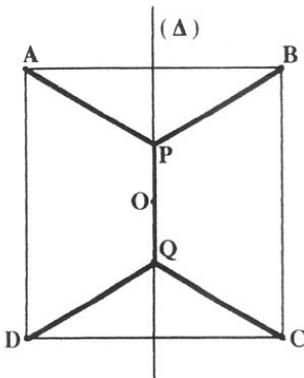
Cherchons maintenant à préciser la position des "nœuds" P et Q de la courbe ainsi déterminée de façon expérimentale (*fig. 3*). Soit O le centre du carré ABCD, et  $(\Delta)$  la médiatrice de [AB]. Il s'agit de déterminer pour quelle(s) position(s) de P et Q la somme  $d = AP + PB + QC + QD + PQ$  est minimale.
