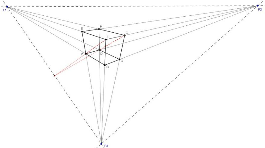
**Figure 1 : un cube en perspective conique**
