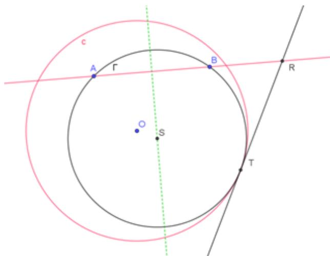
Le nombre  $RT^2$  est la puissance du point R par rapport aux deux cercles C et  $\Gamma$ , on a donc  $P(R, \Gamma) = RT^2 = \overline{RA} \times \overline{RB}$
