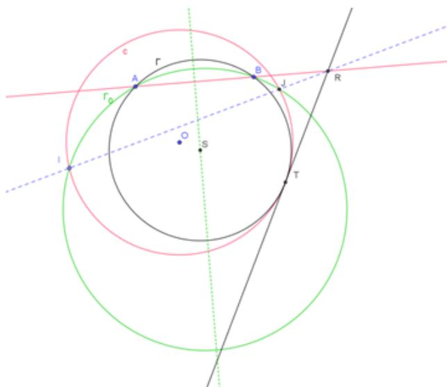
En conséquence, pour construire le cercle  $\Gamma$ , il suffit de construire R comme intersection de la droite (AB) avec la droite (IJ), les points I et J étant les points d'intersection du cercle C et d'un cercle « auxiliaire » passant par A et B.
