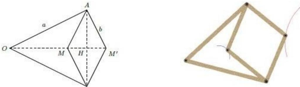
En mécanique, cela fournit un moyen efficace de transformer un mouvement circulaire en mouvement rectiligne (ou inversement) sans contrainte latérale comme dans le système de piston et bielle.
