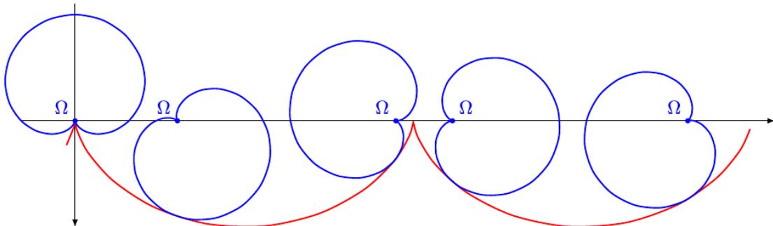
Et le diagramme de vitesse du véhicule a cette particularité que la vitesse s'annule lorsque le point de rebroussement de la roue (l'axe) passe au point de rebroussement de la route :
