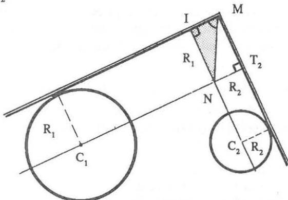
On en est conduit à introduire des "marchepieds" (lignes auxiliaires), ce qui aboutit à un rectangle de diagonale MN, soit  $\sqrt{R_1^2 + R_2^2}$ .
