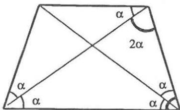
Cela suggère que la figure à construire est obtenue à partir de quatre sommets d'un pentagone régulier, figure que l'on sait construire à la règle et au compas.
