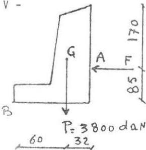
Le mur de soutènement représenté ci-contre en coupe, a un poids de 3 800 daN appliqué en G. Il doit pouvoir supporter la poussée des terres  $F$  avec un coefficient de sécurité égal à 1,8.
