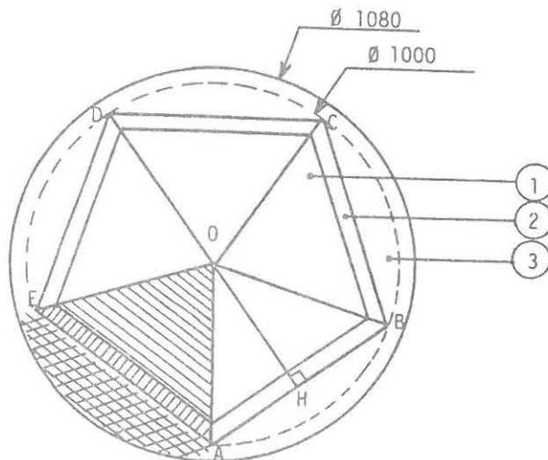
On vous demande de réaliser un plateau de table circulaire de 1080 mm de diamètre, décoré d'un motif en forme de pentagone régulier inscrit dans un cercle de 1000 mm de diamètre (voir schéma).
