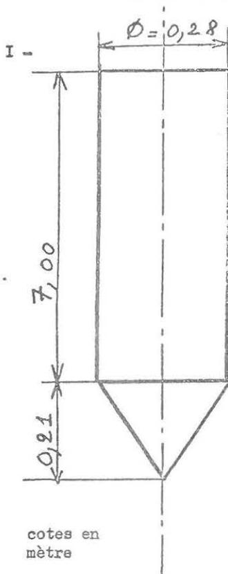
On veut enfoncer un pieu en béton armé préfabriqué (cylindrique et terminé par un cône) à l'aide d'une sonnette. Lorsque l'opération est terminée le pieu recépé a les cotes indiquées sur le schéma.
