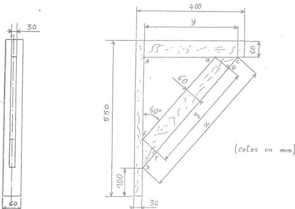
On veut réaliser la console ci-dessus en chêne de masse volumique  $\rho = 900 \text{ kg / m}^3$ .
