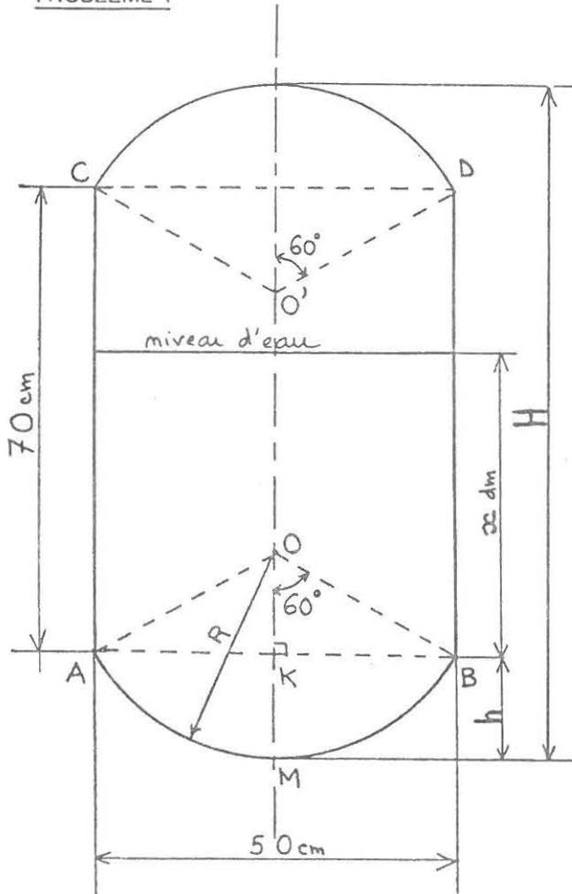
Une cuve est constituée par un cylindre et par deux segments sphériques.
