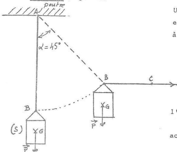
Un solide (S) de masse  $M = 100 \text{ Kg}$  est suspendu par un câble [AB] à une poutre.
