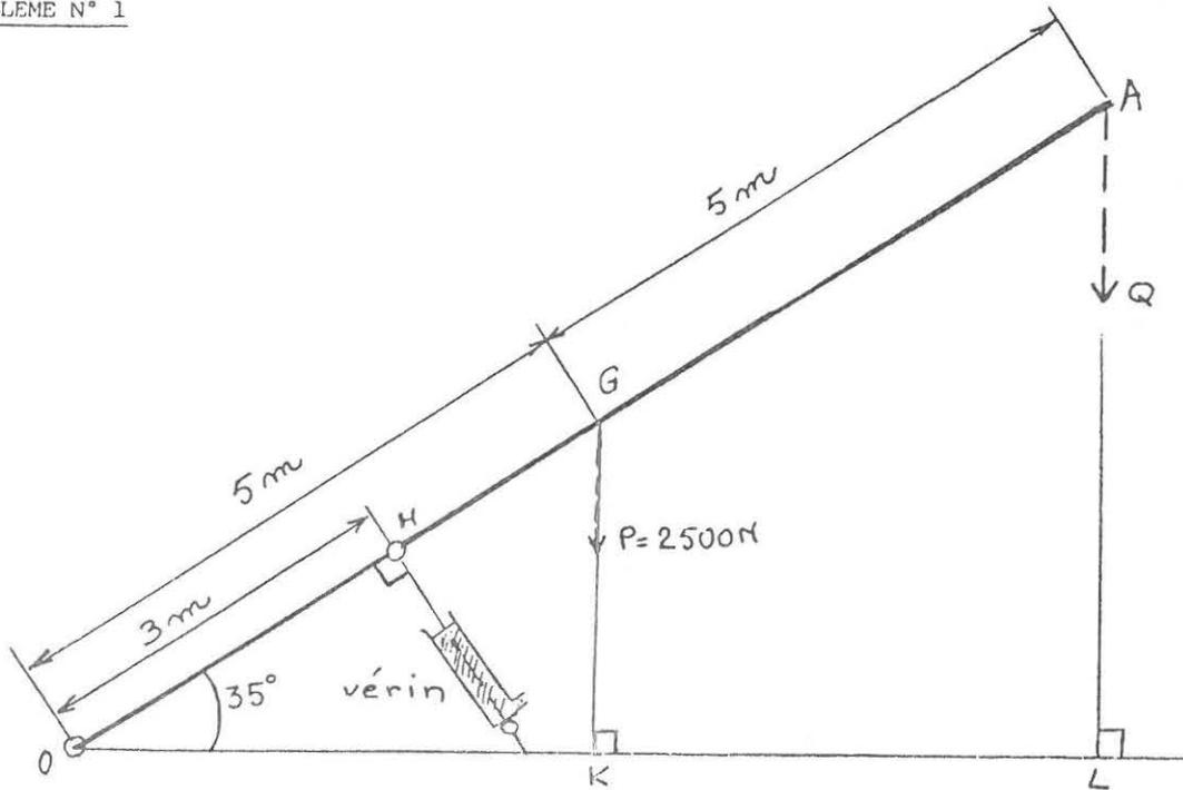
La poutre OA mobile autour de O est en équilibre dans la position indiquée par le schéma.
