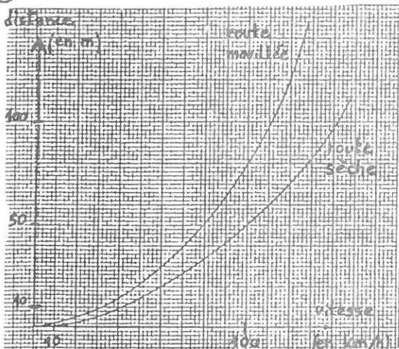
Le diagramme ci-contre donne les distances moyennes de freinage sur route sèche et sur route mouillée en fonction de la vitesse du véhicule.
