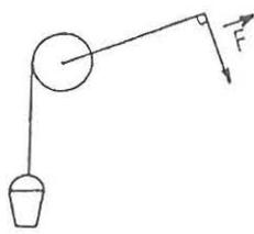
La manivelle d'un treuil a une longueur de 50 cm et le cylindre sur lequel s'enroule la corde a un rayon de 10 cm.
