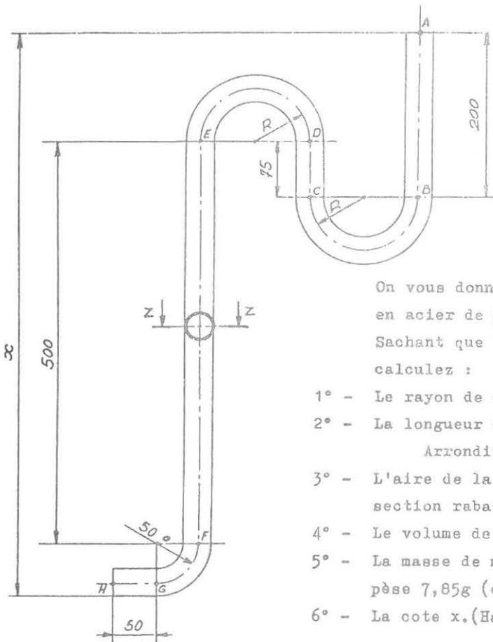
On vous donne ci-contre le dessin d'un tuyau en acier de  $\varnothing 15$  intérieur et de  $\varnothing 21$  extérieur. Sachant que la mesure de l'arc  $\widehat{BC} = 188,4$ , calculez :
