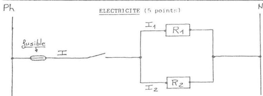
$R_1$  et  $R_2$  sont des résistances.  $I$ ,  $I_1$ ,  $I_2$  sont les intensités de courant dans les différentes branches.
