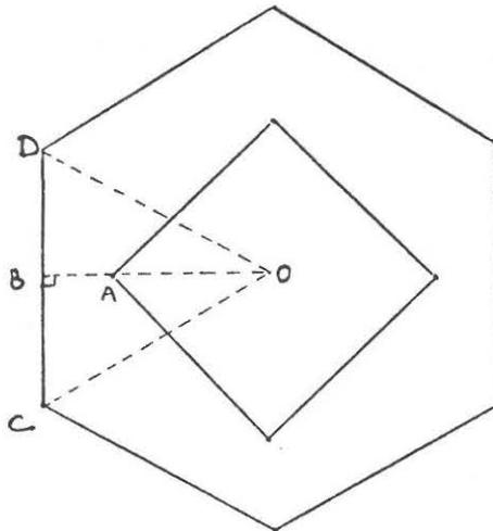
Ce croquis représente la section d'un pilier en béton. La partie centrale est carrée, la partie extérieure est un hexagone régulier convexe. On donne les dimensions  $OA = 25 \text{ cm}$   $OB = 35 \text{ cm}$
