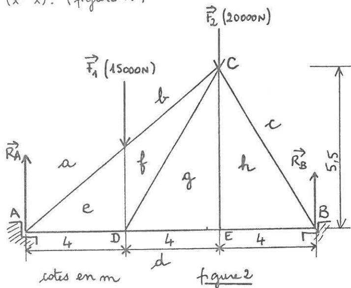
5) La toiture d'un hangar est supportée par des fermes en shed. (figure 2)
