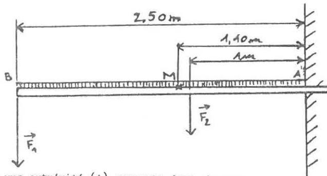
La poutre encastrée à une extrémité (A) supporte deux charges
