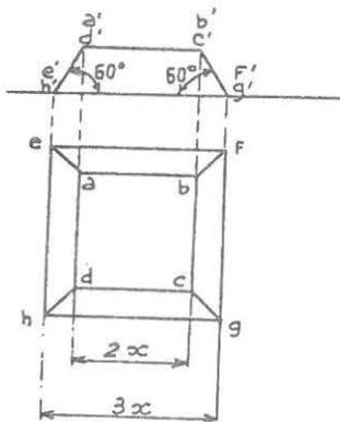
La figure ci-contre représente l'épure d'un bloc ayant la forme d'un tronc de pyramide régulier. Les côtés des bases carrées ont pour mesure  $(2x)$  et  $(3x)$ . Chaque face latérale fait avec la base un dièdre de mesure  $60^\circ$ .
