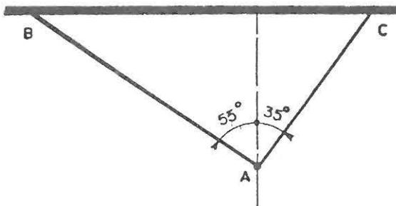
Un corps (A) assimilable à un point matériel, de poids  $P = 36 \text{ N}$  est suspendu par l'intermédiaire de 2 fils (AB) et (AC). Le corps (A) est en équilibre.
