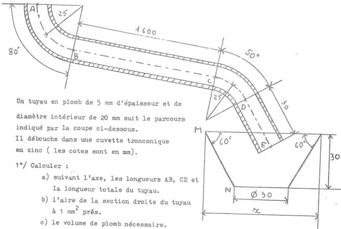
Un tuyau en plomb de 5 mm d'épaisseur et de diamètre intérieur de 20 mm suit le parcours indiqué par la coupe ci-dessous. Il débouche dans une cuvette tronconique en zinc ( les cotes sont en mm).
