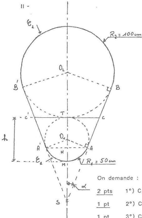
La figure ci-contre représente la section d'un tuyau d'égoût en béton.
