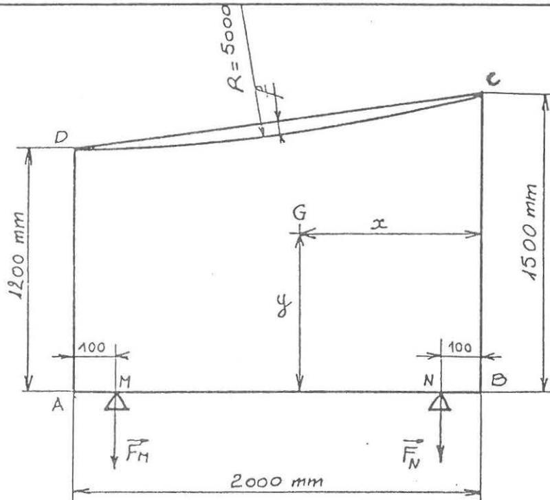
La figure ci-dessus représente un portail en bois massif d'épaisseur 35 mm (masse volumique du bois  $850 \text{ kg/m}^3$ ).
