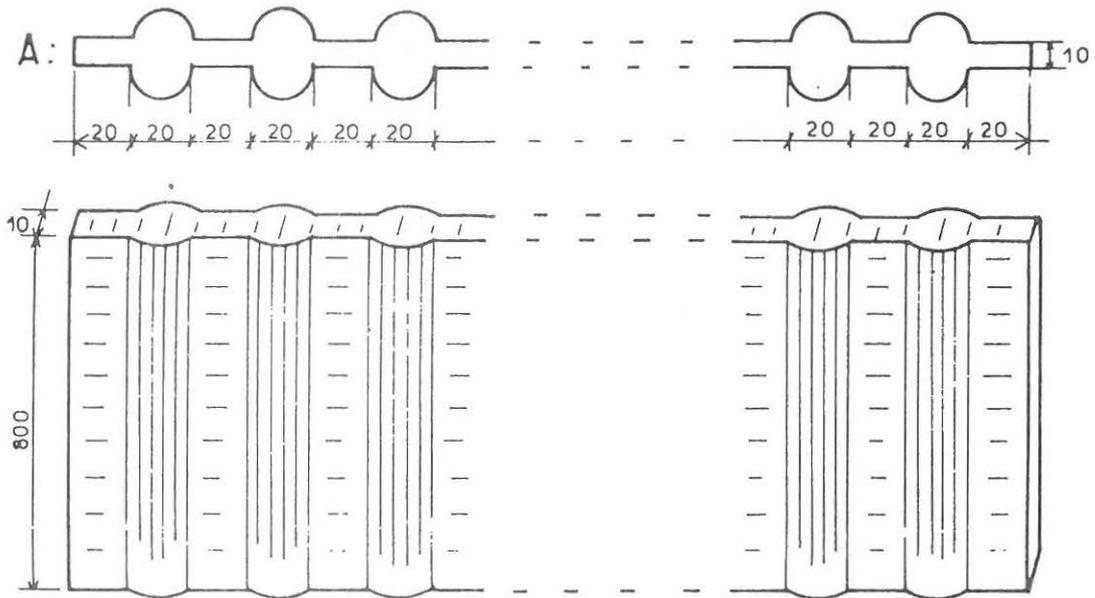
Un radiateur à eau chaude est formé d'une suite de surfaces planes et de surfaces semi-cylindriques comme l'indique la figure ci-jointe, A étant la section droite du radiateur.
