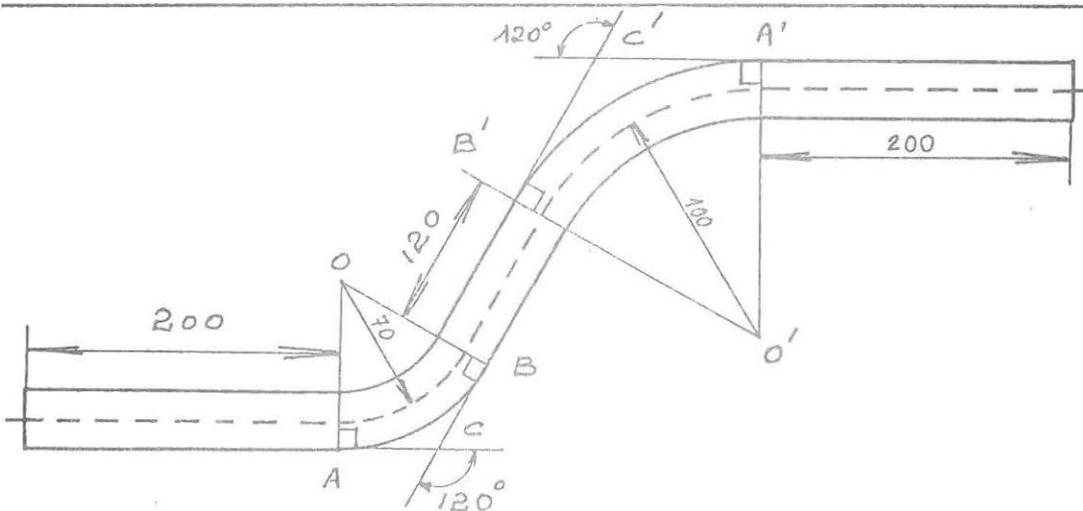
On utilise un tuyau de plomb de diamètre intérieur 10 mm et d'épaisseur 5 mm pour effectuer le travail indiqué par le croquis ci-dessous, les deux coudes sont ouverts à  $120^\circ$  et les rayons des cintrages sont de 100 mm et 70 mm.
