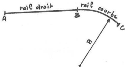
Pour compenser les effets de la force d'inertie centrifuge, on donne d'ailleurs à la voie un "dévers" (virage relevé), fonction du rayon de courbure.
