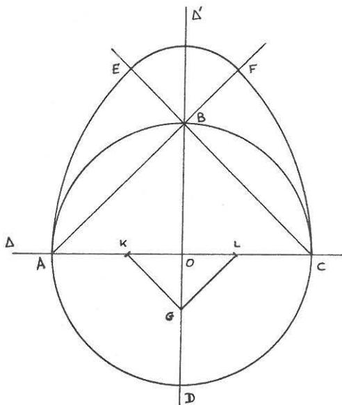
1° les droites  $\Delta$  et  $\Delta'$  n'étaient pas "suffisamment" perpendiculaires ; de ce fait, l'arc de cercle de centre B et de rayon BE ne passait pas par le point F ;
