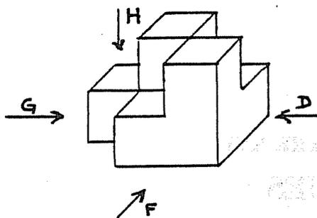
Partons par exemple du solide représenté ci-contre. Les différentes directions de vue sont représentées par des flèches. On pourrait aussi recourir à des cubes coloriés et orientés de façon que la vue de face soit entièrement rouge, la vue de droite bleue, etc. Voici d'abord les contours extérieurs. Ils ne permettent pas de reconstruire le solide.
