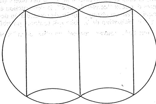
Les centres des cercles n'apparaissent pas (le maître a lui utilisé un gabarit pour la construction), seuls figurent les tracés correspondant aux lignes de pliage.
