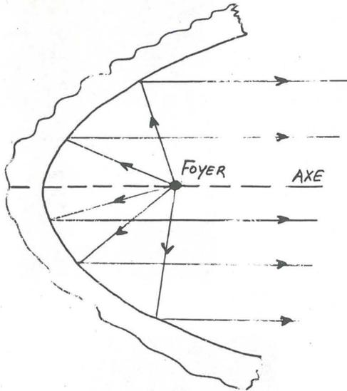
Surface parabolique... radars - électronique - télescopes...
