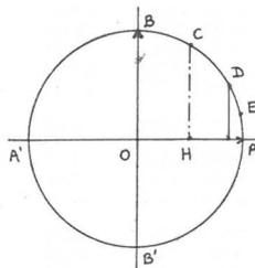
Partager ensuite le cercle en 24 arcs égaux et le graduer en degrés et en radians à partir du point A, en tournant dans le sens contraire des aiguilles d'une montre.
