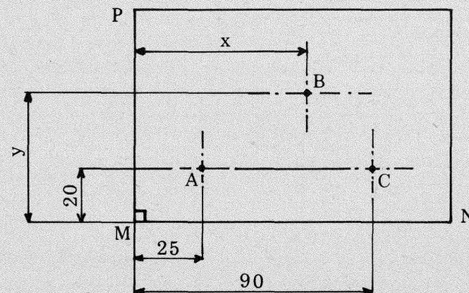
Le dessin représente la face supérieure d'une pièce rectangulaire bloquée sur la table d'une semi-pointeuse.
