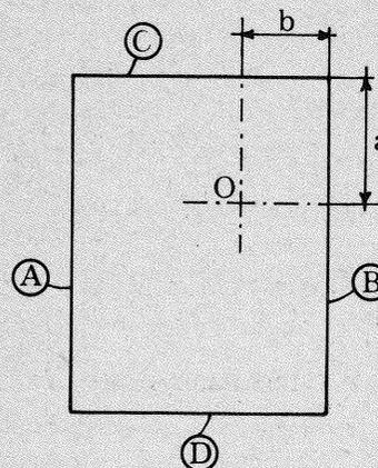
Il s'agit de forer un trou d'axe O (a,b) et de diamètre d, dans une pièce prismatique rectangulaire.
