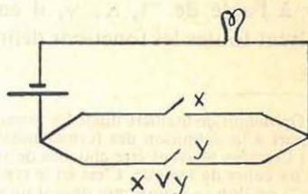
Exemple d'application : pour réaliser un « va et vient » on aura à réaliser :
