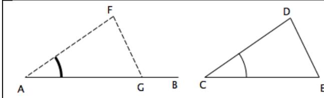
Pour construire sur AB un angle égal à DCE, construire le triangle AGF avec des côtés égaux à ceux du triangle CED (**prop 22**)
