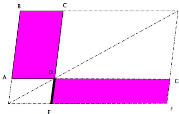
On construit d'abord un parallélogramme ABCD égal au triangle donné (**prop I-42**), puis un second DEFG « appliqué sur » DE et égal au premier. La construction est indiquée par les lignes en pointillés.
