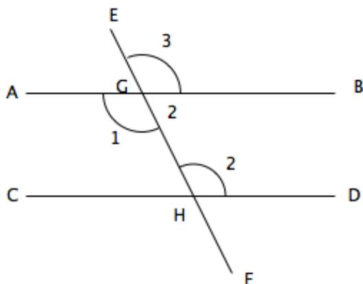
Les droites AB et CD étant parallèles, il s'agit de montrer que  $\angle G1 = \angle H2$ ,  $\angle G3 = \angle H2$  et  $\angle G2 + \angle H2 = 2$  droits.
