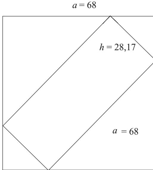
Dans le plan perpendiculaire aux arêtes de contact, la figure fait apparaître deux triangles rectangles, l'un d'hypoténuse  $a$ , de côtés  $b$  et  $c$ , l'autre d'hypoténuse  $h$  (hauteur inconnue du parallélépipède), de côtés  $a - b$  et  $a - c$ . On a donc :
