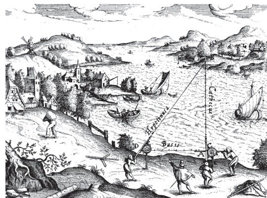
Figure 11. Détermination de la largeur d'une rivière.
