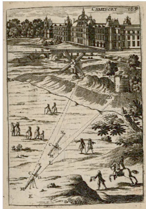
Figure 17. Des arpenteurs utilisant un bâton de Jacob ▶ .
