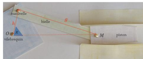
Figure 3. Bielle-manivelle en carton et attaches parisiennes.
