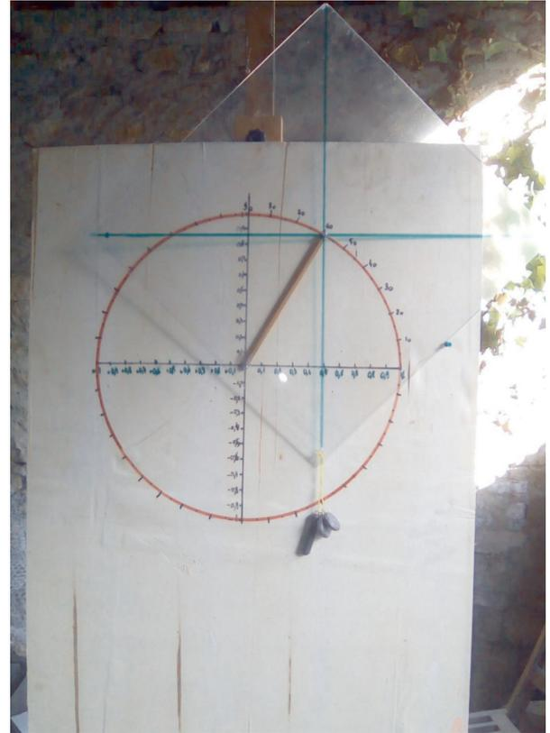
Pour lire cette fois les sinus d'un angle donné ainsi que les cosinus des angles compris entre  $\pi$  et  $2\pi$ , il va falloir un peu plus qu'un fil à plomb. On fait un trou au centre d'une plaque de plexiglas, on trace deux droites perpendiculaires sécantes en ce trou. On leste cette plaque sur une de ses verticales, avec un lest d'environ 200 grammes.
