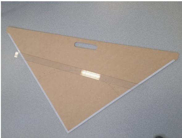
À l'aide de cet objet, on peut déterminer le cosinus et le sinus d'un angle aigu donné, ou encore à partir de la valeur d'un cosinus, déterminer la valeur de l'angle aigu et la valeur du sinus. On pourra dessiner le cercle trigonométrique et utiliser les propriétés des angles associés pour trouver les solutions sur le cercle entier.
