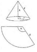
le volume V du cône s'écrit  $V = \frac{1}{3}Bh = \frac{\pi}{3}r^2h$ où B désigne l'aire de la base du cône.
