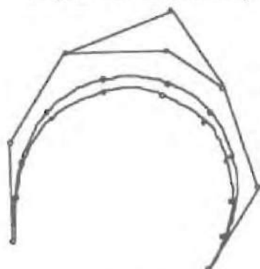
Changement d'un point
