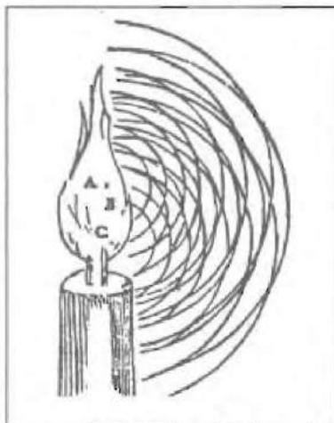
Il s'agit bien, cette fois, d'un **modèle** géométrique d'onde lumineuse et d'un **modèle-image** de l'éther. Chaque point d'une source lumineuse émettant une onde sphérique (du moins dans un milieu optiquement isotrope), l'onde globale produite par la source est l'enveloppe de toutes les ondelettes composantes.
