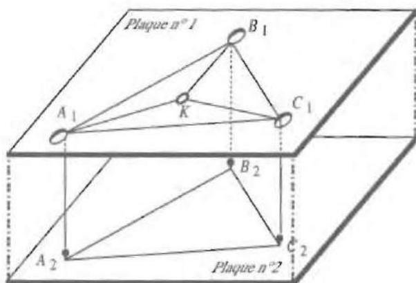
Percez la première plaque en  $A_1, B_1$  et  $C_1$ . Vissez des pitons sur la deuxième plaque en  $A_2, B_2$  et  $C_2$ . A un petit anneau K posé sur la première plaque attachez trois ficelles. La première relie K à  $A_2$  en passant par le trou  $A_1$ , et a pour longueur  $BC + D$ , D étant une longueur arbitraire. De même reliez K à  $B_2$  en passant par  $B_1$  avec la longueur  $CA + D$ , et K à  $C_2$  en passant par  $C_1$  avec la longueur  $AB + D$ .
