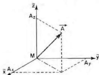
Figure 3 : Construction des composantes cartésiennes  $A_x, A_y, A_z$  d'une grandeur vectorielle  $\vec{A}$  à l'aide du segment orienté qui la représente et des axes locaux  $M\hat{x}, M\hat{y}, M\hat{z}$ .
