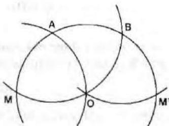
2) Soit deux points  $A$  et  $B$ . La perpendiculaire en  $B$  à la droite  $\mathcal{D}(A, B)$ , est obtenue par deux de ses points constructibles avec le compas à partir de  $\{A, B\}$ .
