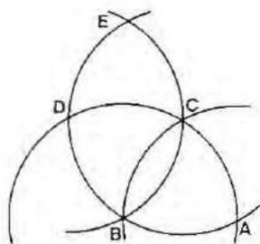
3) Soit deux points  $A$  et  $B$ . La médiatrice du segment  $[AB]$  est obtenue par deux de ses points constructibles avec le compas à partir de  $\{A, B\}$  (figure 4)
