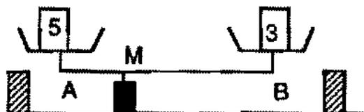
Le problème est de trouver le point d'équilibre. Dans un premier temps, on va faire des expériences. Mais l'objectif est de trouver une loi qui permette de prédire la position de M en fonction des masses placées sur les plateaux.
