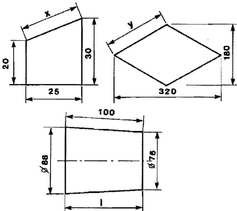
1.2. Tracer les triangles rectangles permettant de calculer la cote inconnue, les désigner, et indiquer la décomposition de la cote cherchée à l'aide d'éléments connus ou que l'on peut calculer.
