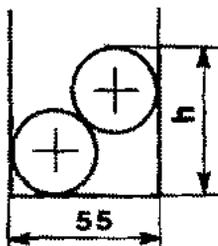
Deux cylindres de 40 mm de diamètre sont placés dans une rainure.
