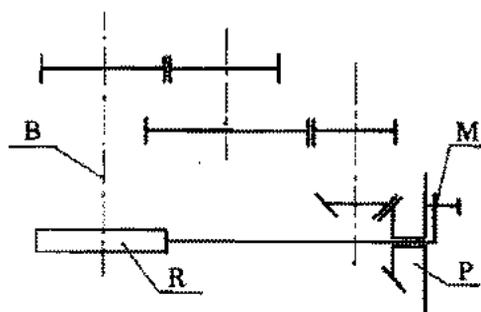
Solution : En établissant un train d'engrenages comportant un couple conique de raison 1 entre l'axe de la broche et le plateau, on crée une liaison cinématique de la manivelle au plateau. La rotation de ce dernier est contrôlée par celle de la manivelle.
