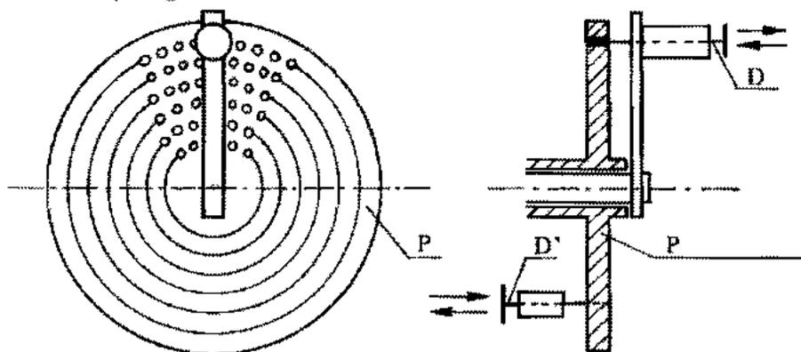
— Un plateau amovible P est monté fou sur l'axe de la vis et de la manivelle. Il est perforé de trous disposés sur six cercles concentriques. Les trous de chaque cercle sont équidistants.
