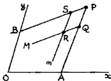
Un système de quatre tiges  $PA, PB, QM, Sm$  forme un parallélogramme articulé  $PQRS$ , qui maintient alignés les points  $A, m, M, B$  quand  $A$  et  $B$  se déplacent dans les glissières qui matérialisent  $Ox$  et  $Oy$ . Quand  $m(x,y)$  décrit une figure,  $M(X,Y)$  décrit sa transformée par  $L$ , si on prend  $\overline{SR} = a\overline{Sm}$  et  $\overline{QR} = \frac{\overline{QM}}{b}$ . En effet
