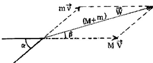
Le premier point matériel a une masse  $M$  et une vitesse  $\vec{V}$ . Le second a une masse  $m$  et une vitesse  $\vec{v}$ . L'angle de leurs trajectoires est  $\alpha$ .
