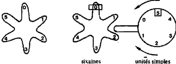
La machine est munie de son couvercle et laisse apparaître les chiffres par les cadrans. On tourne la manette des unités et le système d'engrenage permet à la machine d'entraîner les autres roues.
